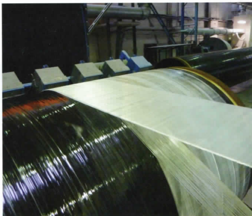
Die in Harz getränkten Glasfasern werden um das Gasrohr gewickelt
