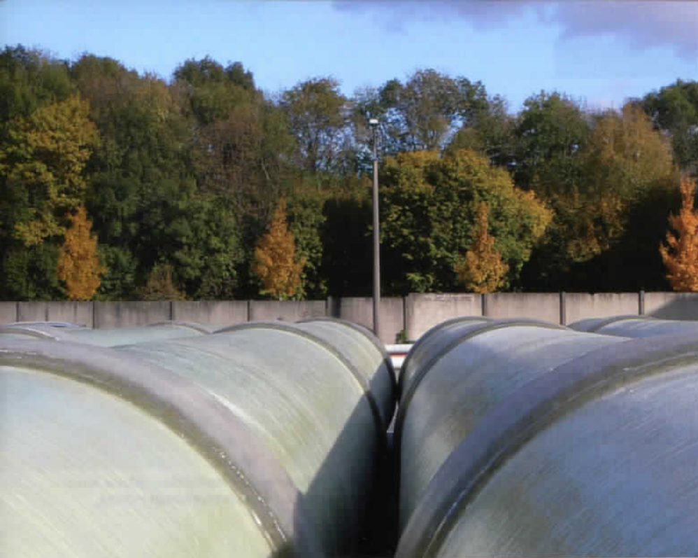
Für die OPAL bestimmte Gasrohre mit der BKP Rohrummantelung und den neu entwickelten Gleitkufen.
