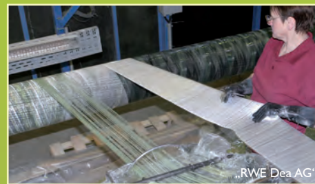
Ummantelung der hochwertigen Edelstahlrohre im Werk der BKP.
